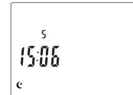
注：掉电状态下，时钟继续正常工作一段时间，随着掉电时间的加长，脱机电量消耗过多，时钟和星期将被系统复位为一个随机值。完全放电后，来电自动开机进入工作状态。
